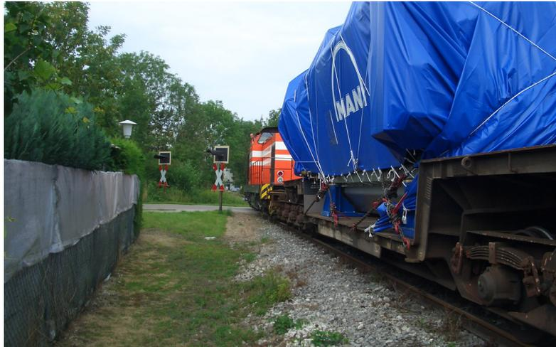
auch im Jubiläumsjahr unserer Bahn die MAN noch immer ihren Gleisanschluss nutzt, ja dass im Zuge einer Produktionsumstellung heute sogar wesentlich mehr Motoren auf Bahn-Tiefladern das Werk verlassen, als noch vor Jahren. Als zweihundert- und mehr tonnen-schweren Großmotoren mittels eines ungewöhnlichen Tiefladege-spanns, von zwei PS-starken (MAN)-Zugmaschinen gezogen und ge-schoben, in drei Nachtmärschen auf besonderen Straßen zum ersten Verschiffungshafen in Heilbronn gebracht wurden.
